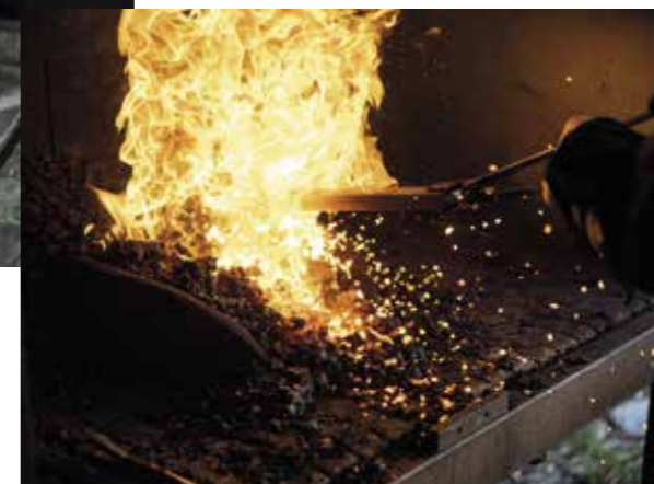
Feuer: „Es braucht viel Erfahrung“, sagt Francois Junco, Damast-Schmied bei Laguiole en Aubrac, „um die Temperatur des Stahls anhand der Farbe beurteilen zu können.“
